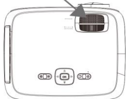
MOLETTE DE RÉGLAGE DE LA MISE AU POINT Ensuite, affinez l'image en tournant la molette de mise au point.
