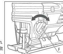
Verwenden Sie die Einstellung 0, wenn Sie Stahl oder ähnliche harte Materialien sägen. Die Sägebewegung sollte klein sein. Nutzen Sie die Einstellung 0 auch für scharferes und genaueres Sägen von weichen Materialien. Diese Einstellung wird auch für dünne Materialien oder Messer-/Feilarbeiten verwendet.
