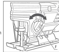
De pendelbeweging kan worden ingesteld van 0 tot 3, waarbij 0 staat voor een recht op-en-neer gaande zaagbeweging en 3 voor de grootste pendelslag. Gebruik stand 1, 2 of 3 bij het zagen in hout, plastic of andere zachte materialen. In dat geval is een grotere pendelslag nodig.
